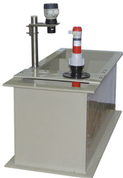
Equipements de mesure montés sur DEBITBAC
