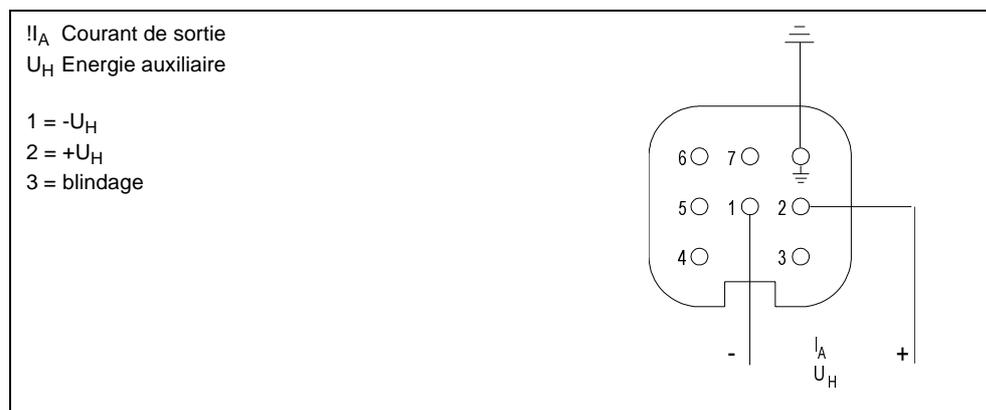
Figure 40 Raccordement par connecteur (Han 7D / Han 8U)
