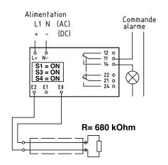
La valeur résistive de boucle devra être comprise entre 1,5 k $\Omega$  et 1 M $\Omega$
