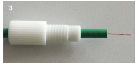
Mettre en place le bouchon d'assemblage sur le câble
