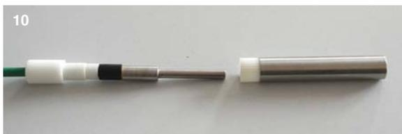
Insérer l'ensemble dans le corps de sonde et serrer le bouchon d'assemblage
