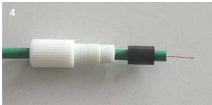
Mettre en place la rondelle-joint néoprène
