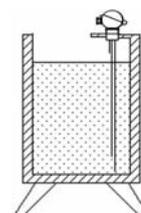
**Entretien :** Pour un meilleur rendement de la sonde, il est conseillé de vérifier de temps en temps, l'état des électrodes.
