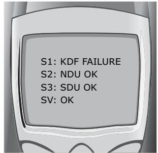
Le SMS affiche KDF FAILURE. Cette information signifie qu'il y a une panne de communication entre le NVO6-11 et le capteur concerné ; motif de panne le plus courant : panne de capteur interne. Contrôle ou remplacement absolument nécessaire.
