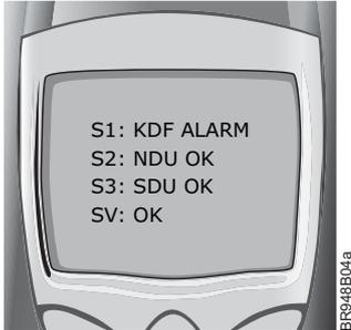
Le SMS affiche KDF ALARM, c'est-à-dire que la couche d'hydrocarbures a atteint son maximum - contrôle absolument nécessaire.
