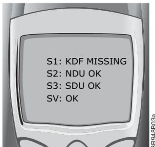
Le SMS affiche KDF MISSING. Cette information signifie qu'il n'y a aucune communication entre le NVO6-11 et le capteur concerné ; motifs de panne les plus courants : court-circuit ou rupture de communication dans le capteur, les assemblages ou les câbles. Contrôle, réparation ou remplacement absolument nécessaires. En cas d'inversion du + et du - sur le câble d'alimentation d'un capteur, le message « MISSING » s'affiche également.
