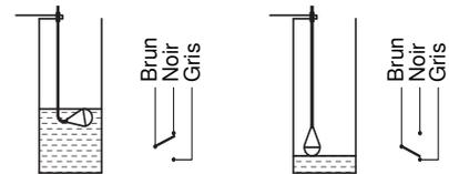
(\*) Pour éviter toute charge électrostatique, le brin jaune/vert du câble de raccordement doit toujours être mis à la terre.
