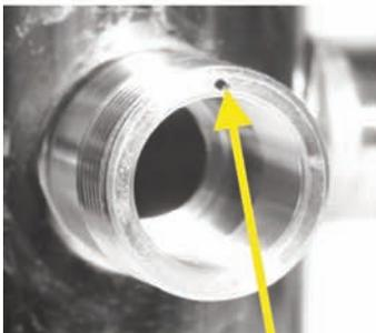
**Veiller à placer le détrompeur dans le trou.**
