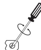
L'instrument doit être réétalonné au moins une fois par mois, ou à chaque fois que la sonde ou la batterie est remplacée.
