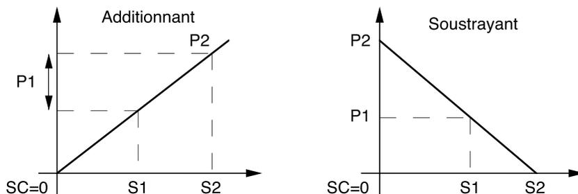
Remarque : en soustrayant, le mode présélections en chaîne et contact préliminaire flottant sont équivalents. Si un repositionnement automatique a été programmé, celui-ci se fait après avoir atteint la valeur P2 en fonctionnement additionnant, et à 0 en fonctionnement soustrayant.
