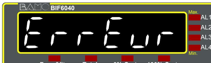
“Erreur” = erreur du microprocesseur. Erreur provenant de l'appareil ou le résultat du calcul à effectuer se situe au delà de la capacité d'échelle. Il est possible de configurer un facteur d'échelle pour obtenir une valeur inférieure à l'échelle maxi.
