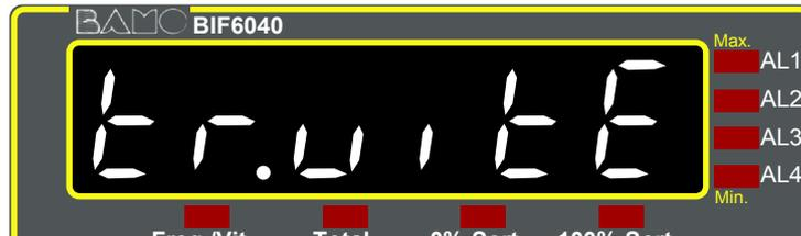
“Trop vite” = La fréquence d'entrée se situe au delà des capacités de l'appareil. Réduisez le signal d'entrée fréquence ou utilisez une autre source de signal (encodeur etc.) présentant un signal de sortie inférieur.
