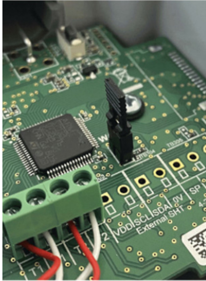
Mode LoRaWAN propriétaire : Jumper positionné sur les deux broches
