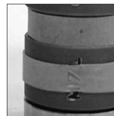
Photo montrant l'évent quand la gaine souple est dégagée
