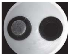
Sombre : contre électrode Brillante : électrode de mesure
