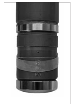
Photo montrant l'évent quand la gaine souple est dégagée
