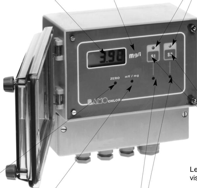
Réglage du zéro lorsque le fluide passe par le filtre à charbon actif.
