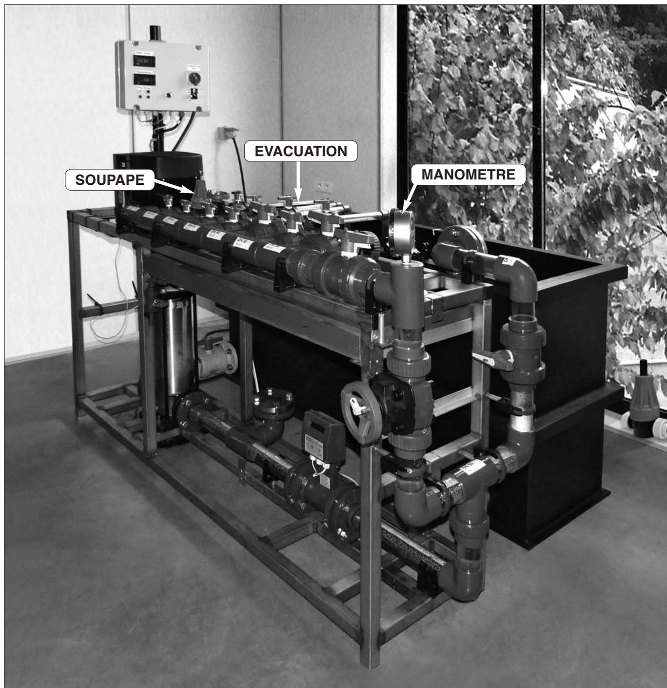
Notre banc de tests hydrauliques, nous permet de réaliser le tarage de vos soupapes et réducteurs de pression à la valeur souhaitée.
