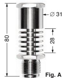
**Radiateur de refroidissement RD (Fig. A) :** Il permet au transmetteur de fonctionner avec des fluides chauds, non agressifs et non cristallisants. Conception tout inox 316 L – Raccord process / instrument 1/2" BSP mâle ou femelle (autres /Dde)
