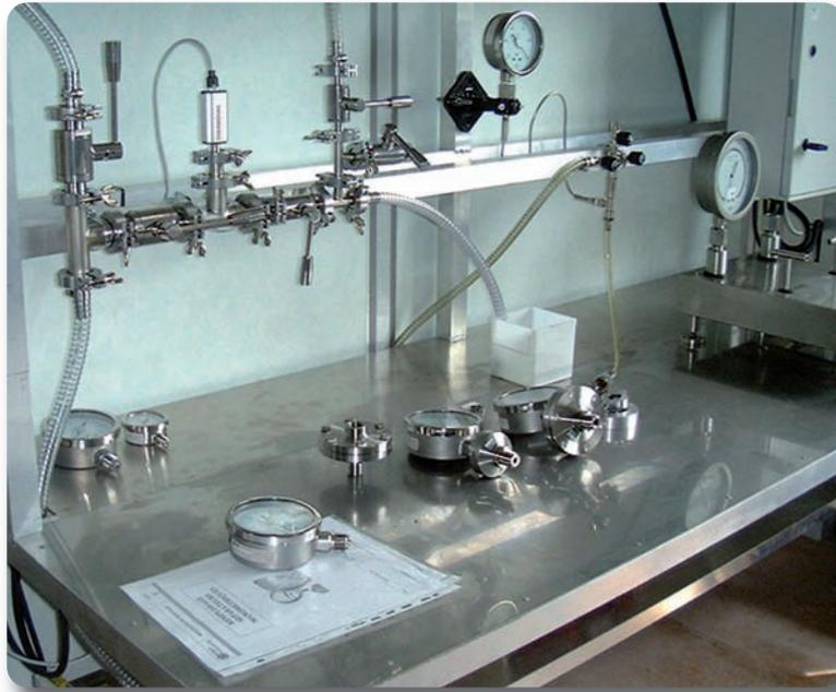
**BAMO dispose d'un banc de remplissage pour le montage de manomètres sur séparateurs.**
