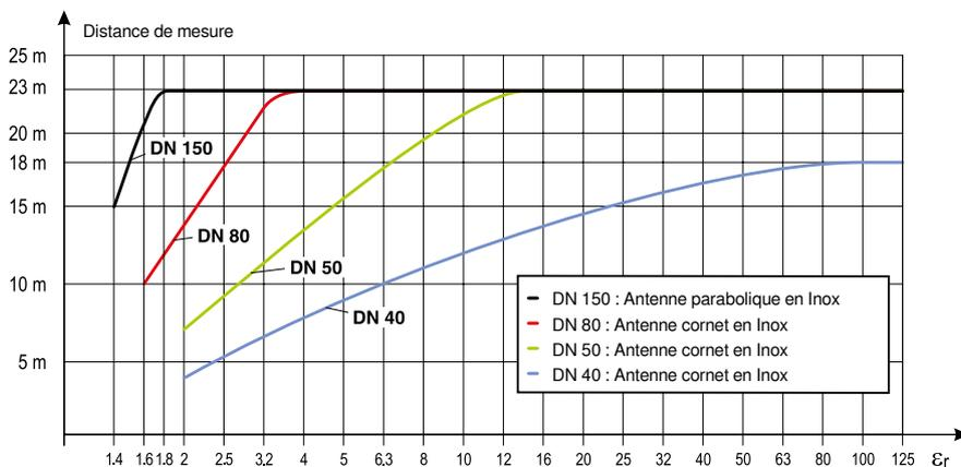
L'utilisation d'une protection plastique (PP) ou la présence de mousse et/ou vapeur entraînent une diminution de la distance de mesure maximale :
