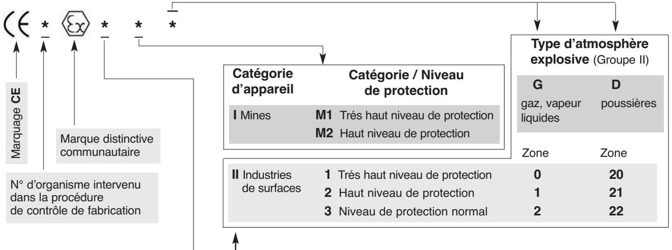
S'il s'agit d'un **Matériel électrique**, il comportera également la ligne suivante :
