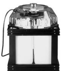
Embouteilleur Polyéthylène 4 X 5 Litres Chacune des 4 bouteilles représente une période de 24 heures sur un programme d'échantillonnage de 4 jours. Une réfrigération de l'échantillon sera nécessaire dans le cas d'eaux usées, biologiquement actives, (polluées).
