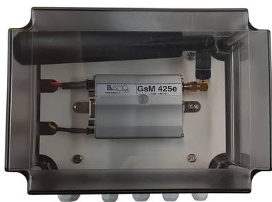
Modem monté dans un boîtier étanche
